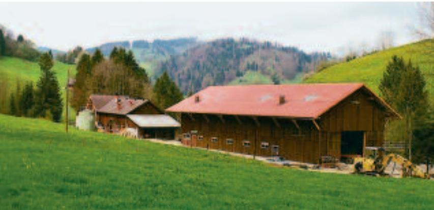
Freistehende Ökonomiebauten sind in der Regel mit einem gleichschenkligen Satteldach zu versehen. Die Firstrichtung verläuft parallel zur Längsseite des Gebäudes. Die Dachneigung soll 30 Grad nicht unterschreiten.
