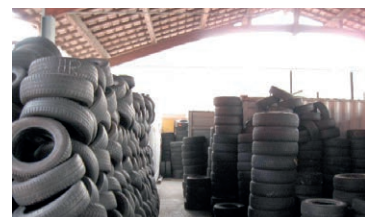
Reifenlager müssen immer mit einem befestigten Boden ausgestattet und nach Möglichkeit überdacht sein.
