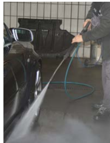
Die Reinigung mit einer Hochdrucklanze spart Wasser.
