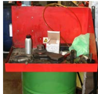
Kleinteilereiniger: Klappdeckel, die bei Nichtbetrieb geschlossen werden.
