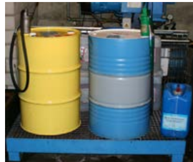
Auslaufende Flüssigkeiten müssen zurückgehalten werden: Auffangwannen beim Gebindelager.
