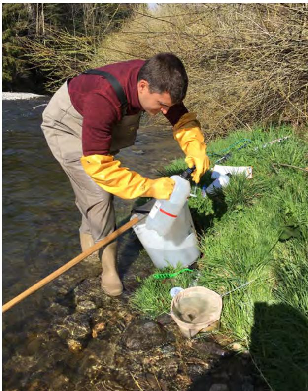
**Abbildung 3** Entnahme von Makrozoobenthosproben am 16.4.2019 mittels Kicksampling und Fixierung der Proben mit reinem Alkohol bei der Untersuchungsstelle 9AI (Sitter ARA Unterschlatt).
