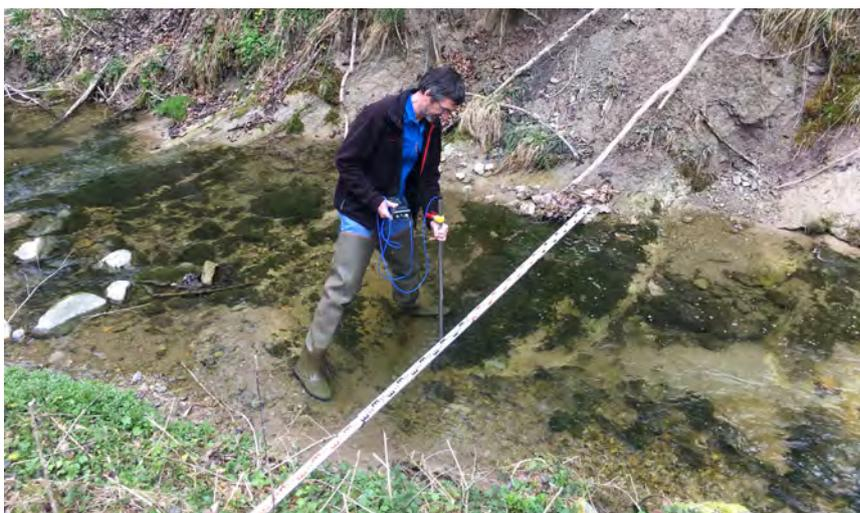
**Abbildung 4** Groberfassung der Abflussmenge durch Messung der benetzten Breite sowie der Strömung und der Wassertiefe an fünf Stellen im Messquerschnitt im Sonderbach bei Moos unterhalb der ARA Hundwil (Stelle 3.21).
