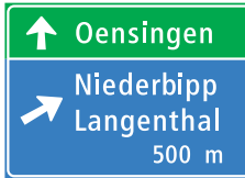
4.61 Vorwegweiser bei Anschlüssen
