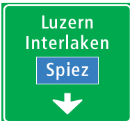
4.69 Einspurtafel über Fahrstreifen auf Autobahnen und Autostrassen
