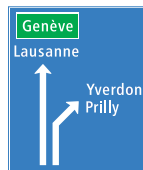
4.38 Vorwegweiser mit Fahrstreifenaufteilung auf Hauptstrassen
